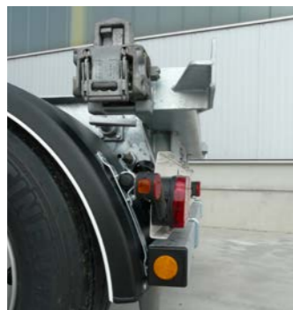
Optimaler Rammschutz für Licht-einheit bei Rampenbeladung
