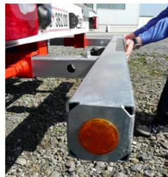
Ausziehbarer Unterfahrerschutz für 45 Fuß Container
