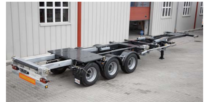
Optimale Lastverteilung und Satellast durch die mittige Aufnahme eines 20 Fuß Containers
