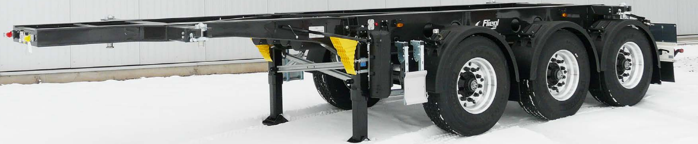
Chemie-Chassis light für 20 Fuß Container und 7,82er Tankcontainer
