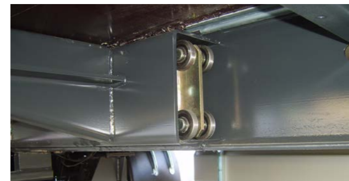
Tandem-Rollenlagerung für Heckausschub
