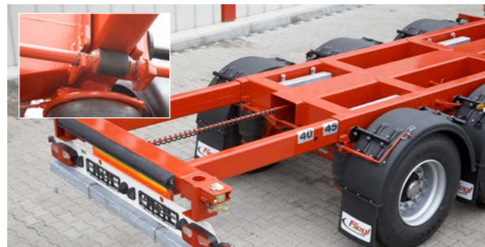
Manueller, rollengelagerter Heckausschub: robust, leichtgängig, störungsunanfällig
