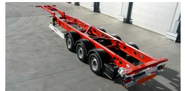
40 bzw. 45 Fuß Chassis in Light-Ausführung ab 3450 kg
