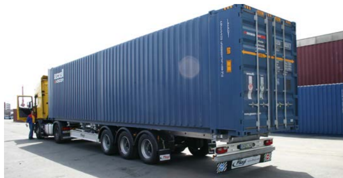
Mit Frontausschub können 45 Fuß Container ohne Sondergenehmigung gefahren werden.
