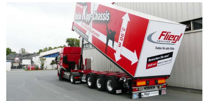
Vario Kipp-Chassis mit 30 Fuß Container in nicht teleskopiertem Zustand
