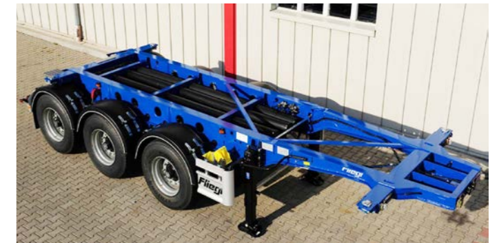
Chemie-Chassis light für 20 Fuß Container und 7,82er Tankcontainer
