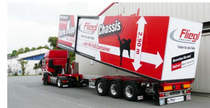
Vario Kipp-Chassis mit 40 Fuß Container teleskopiert
