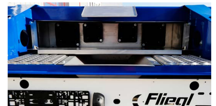
Edelstahl-Schlauchkasten mit Ablauf für Schlauchrohre
