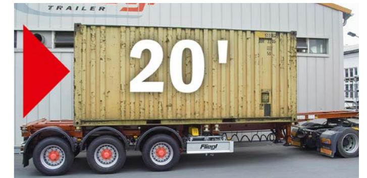
Vario Chassis V3 mit Verschiebeeinrichtung für 20 Fuß Container
