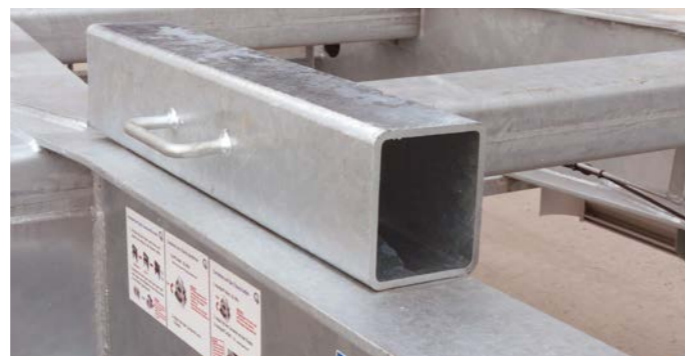
Stabile Auflageblöcke für 20 Fuß Container im vorderen Bereich des Chassis
