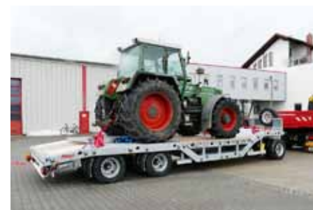
Podvalník DTS 300 pro převoz zemědělské a stavební techniky
