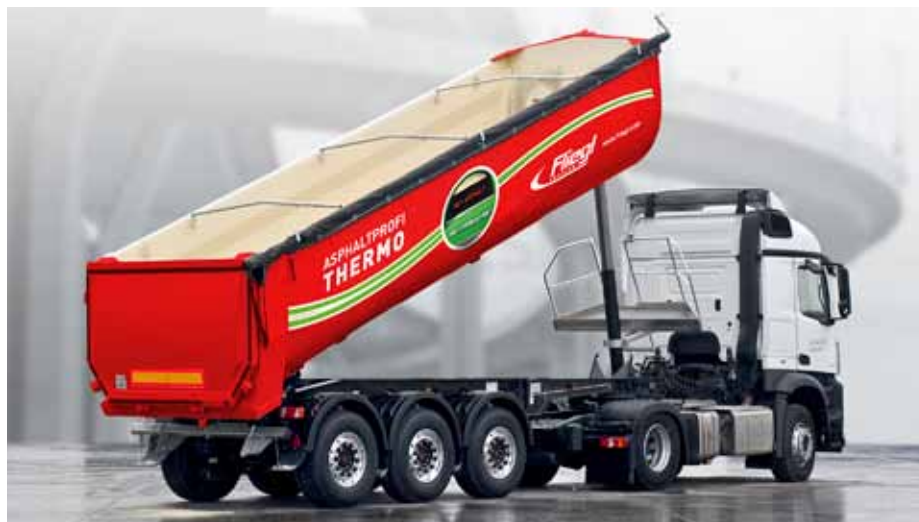
Sklápěcí návěs s termoizolací pro převoz asfaltu
